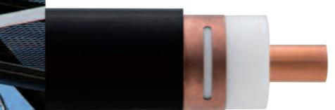
누설 동축 케이블은 안테나를 설치하기 어려운 환경에 활용됩니다. 특정 주파수에 최적화한 설계가 가능하고, 광대역으로 사용이 가능할 뿐만 아니라 터널 벽면이나 기둥 등 설치 환경에 따라 자유롭게 슬롯 설계가 가능합니다.
